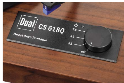
Również CS 618Q obsługuje trzy prędkości obrotowe, przełączane wygodnym pokrętelem.
